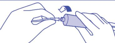
シリジポンプにセットする前に、十分注意して外筒内のエアーを抜き取る。
