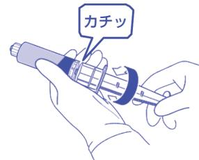
押子をまっすぐ挿入し、押子接続用部品に軽く突き当てた後、押子を時計回りに回し、しっかりと接続すること（カチッという音がしたら、それ以上押子を回転させないこと）。〔押子の接続が適切でない場合、“サイフォニング”（自然落下による急速注入）や“逆流”が起こるおそれがある。また、ガスケットが歪んだり、ガスケットと押子接続用部品の間に隙間があると、エアー混入、液漏れやシリジポンプの残量警報が発報しないおそれがある。〕
